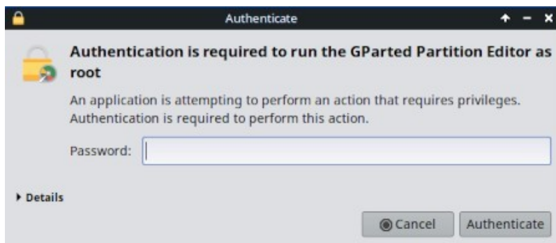
Figura 4-12: Caixa de diálogo quando o comando pkexec é utilizado (sem armazenamento).
